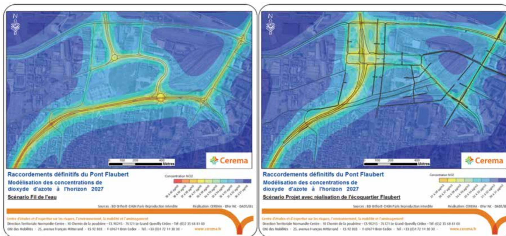
➤ Schéma 389 : Modélisation de la dispersion : Résultats pour le dioxyde d'azote (Étude air - CEREMA - Oct. 2015 - Annexe 1)
