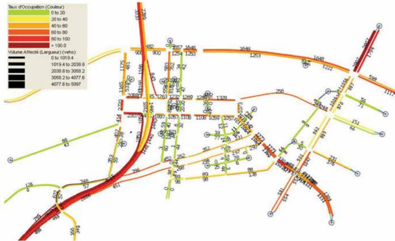
➤ Schéma 383 : Demande de trafic modélisée entre 8h00 et 9h00 (Simulation dynamique de trafic - CETE Normandie-Centre - Aout 2013 - Annexe 16)
