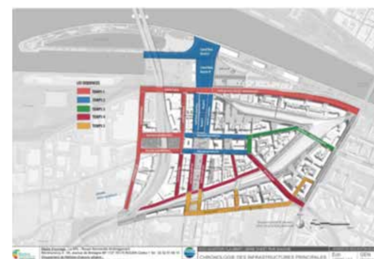
Schéma 24 : Détail du séquençage indicatif de l'urbanisation et des aménagements en 6 temps (Étude d'impact du dossier de réalisation de ZAC - Déc. 2015)
