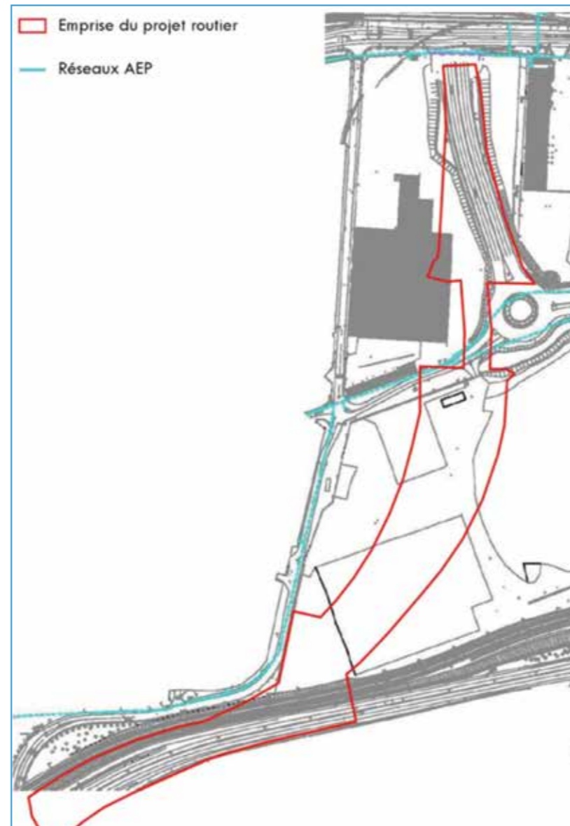
➤ Schéma 242 : Réseaux d'alimentation en eau potable à proximité des emprises du projet (EGIS)
