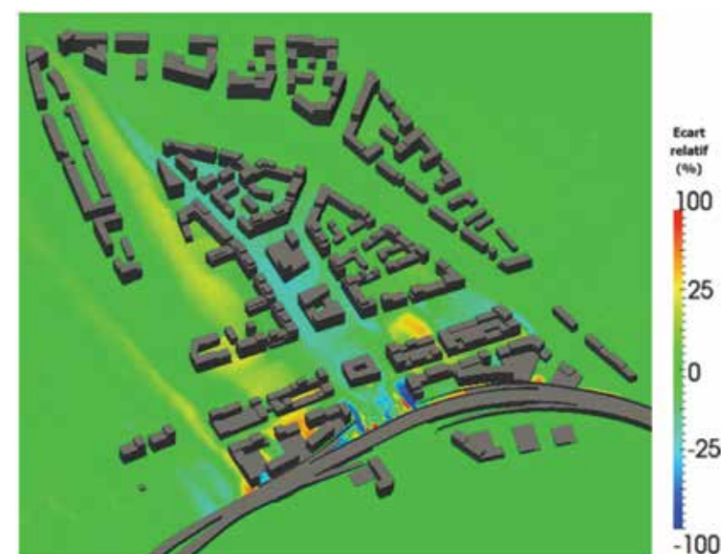
➤ Schéma 358 : Ecart relatif exprimé en % entre les configurations V3 (haut et bas) pour les dépôts particuliers PM10 (NUMTECH - Mars 2015 - Annexe 2)
