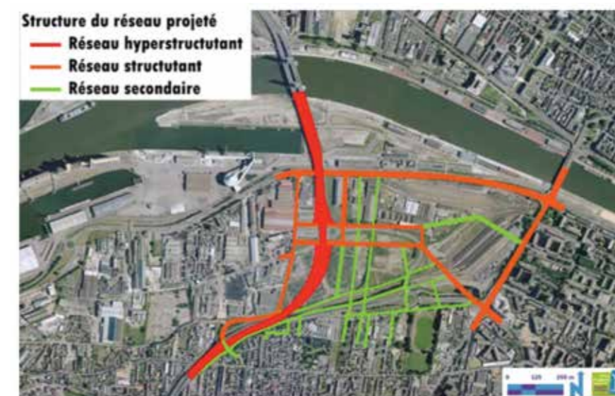
➤ Schéma 300 : Structure générale du réseau viaire projeté
