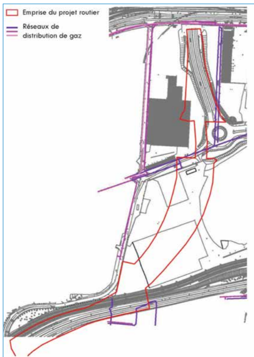
➤ Schéma 248 : Réseaux gaz à proximité des emprises du projet (EGIS)
