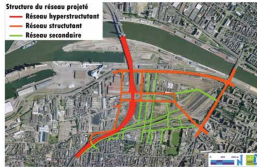
➤ Schéma 300 : Structure générale du réseau viaire projeté
