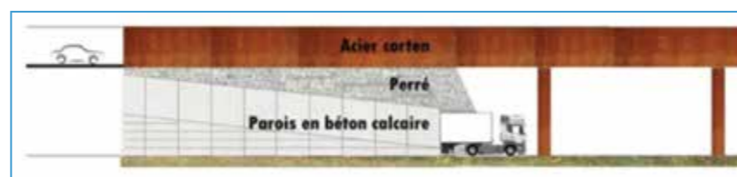
➤ Schéma 293 : Combinaison des matériaux retenus au niveau de l'ouvrage d'art Madagascar (AJOA/ORSI/EGIS - Avril 2016 - Annexe 14)
