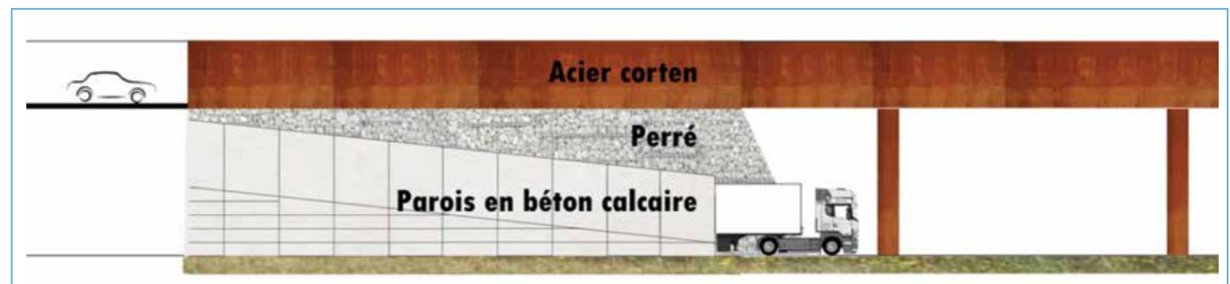
➤ Schéma 89 : Déclinaison du traitement architectural des séquences 3 et 5 (AJOA/ORSI/EGIS - Avril 2016 - Annexe 14)
