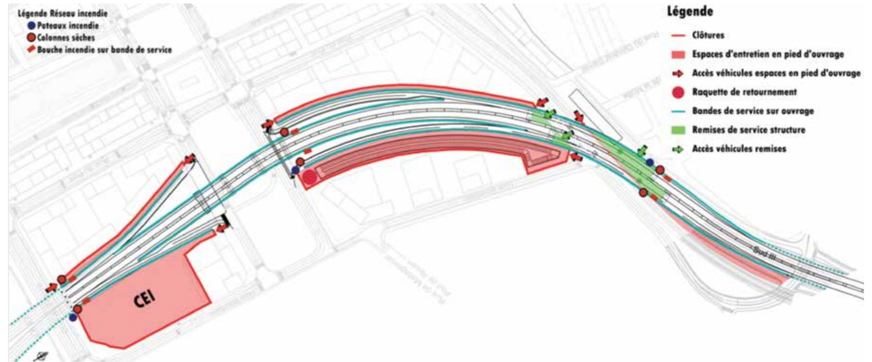
➤ Schéma 98 : Dispositions d'entretien des ouvrages et des équipements en situation aménagée
