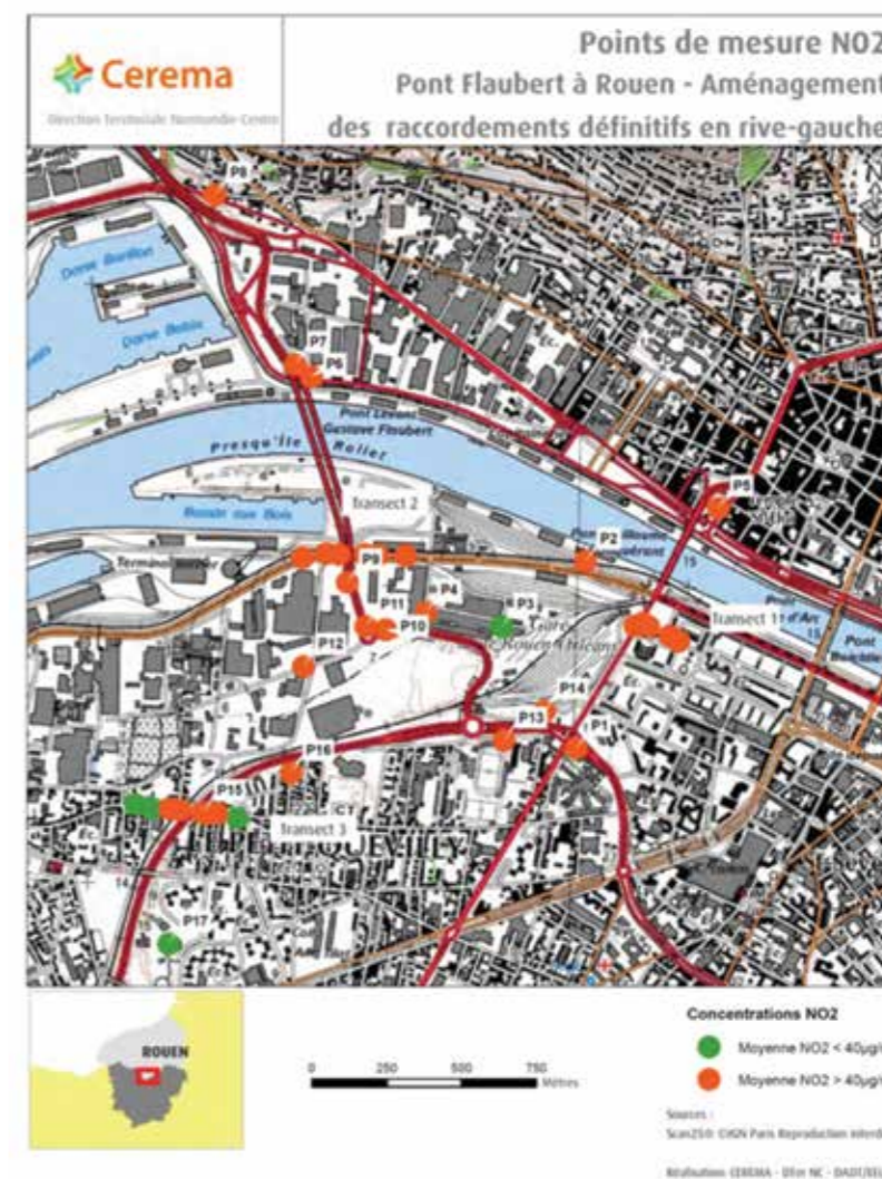
Schéma 32 : Synthèse des résultats des mesures du NO 2 comparés à la valeur limite (Étude air - CEREMA - Oct. 2015 - Annexe 1)
