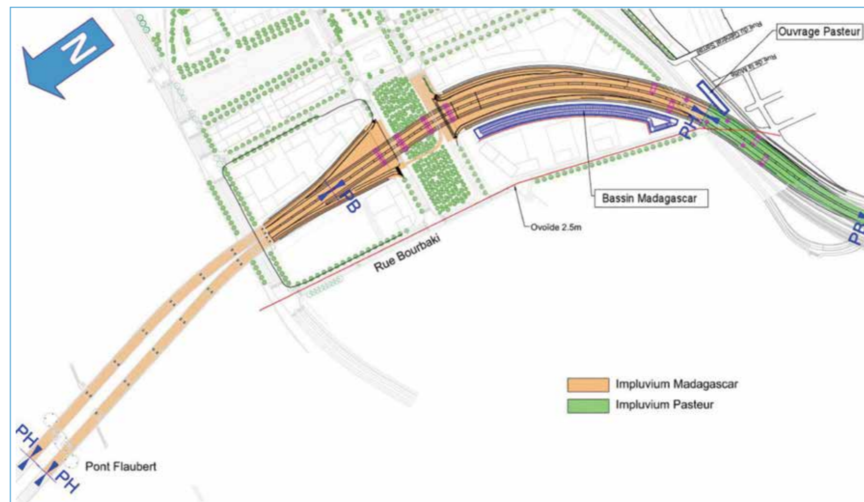
➤ Schéma 94 : Vue en plan des deux impluviums du projet (Notice sur l'Assainissement - DIRNO - Sept. 2015 - Annexe 5)
