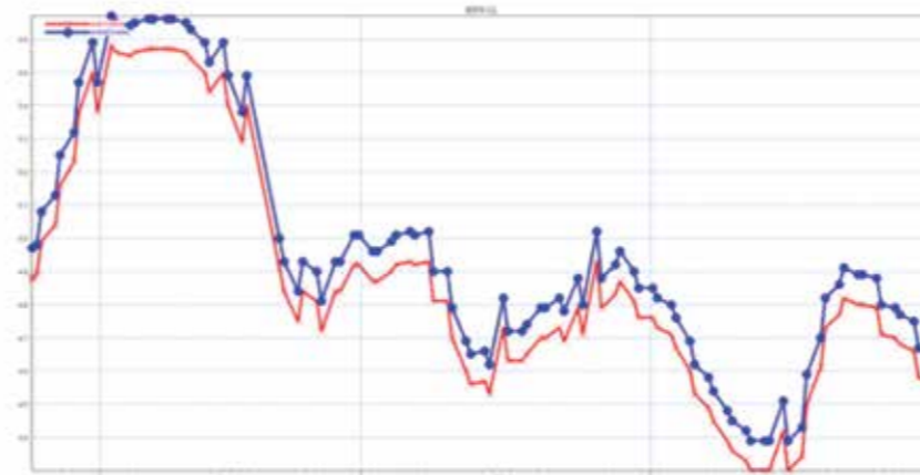
➤ Schéma 176 : Limnigrammes amont (courbe bleue) et aval (courbe rouge) du modèle pour la crue de 1910 (Études hydrologiques, hydrogéologiques et d'assainissement - INGETEC - Mai 2015 - Annexe 3)
