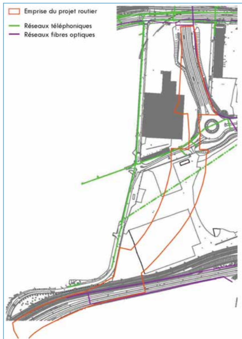
➤ Schéma 251 : Réseaux téléphoniques et fibres optiques à proximité des emprises du projet (EGIS)
