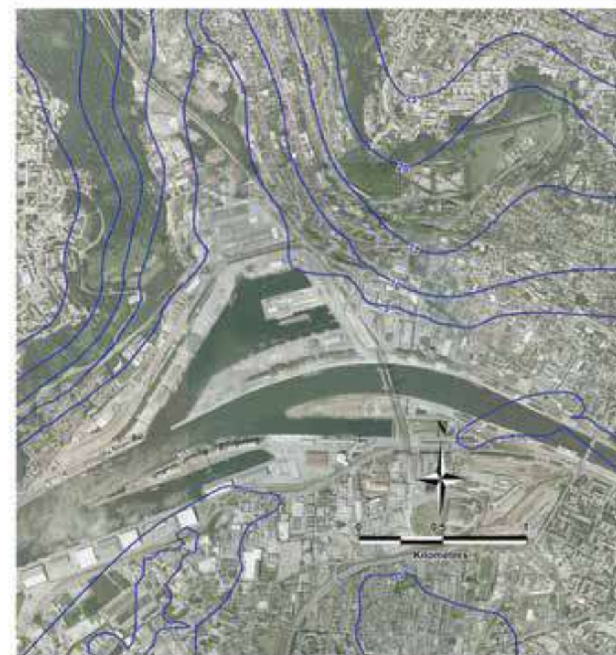
Schéma 13 : Esquisse piézométrique de la nappe de la Craie à Rouen (m NGF)
