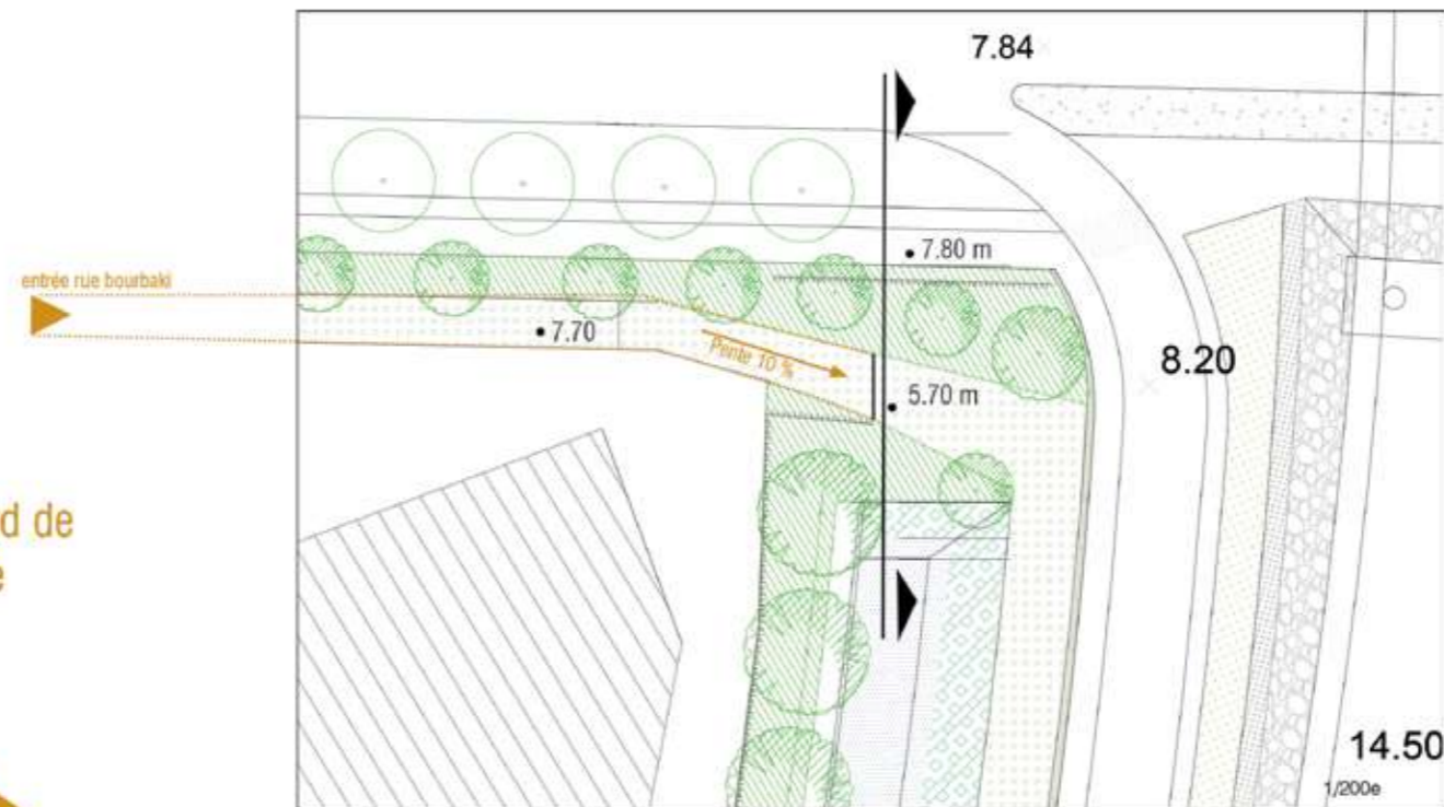
hypothèse 2 B : accès entretien côté Ouest au niveau de la rue Bourbaki, Servitude au nord de la parcelle privée
