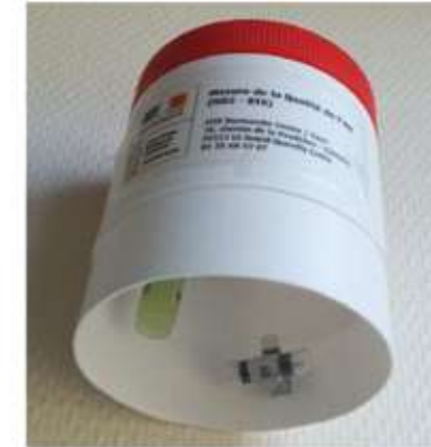
Figure 19: Dispositif de mesure avec un tube BTX et un tube NO2 (CEREMA DTerNC)
