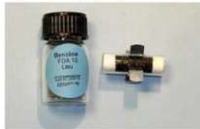
Figure 18: Tube BTX avec système d'accroche (CEREMA DTerNC)
