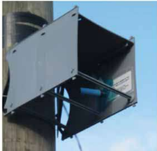
Figure 20: Dispositif de mesure pour les aldéhydes avec matériel Radiello (CEREMA DTer NC)
